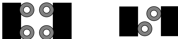
图 18 低频大电容过孔放置
